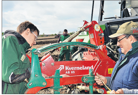
Azubi Martin Willkomm (l.) aus der LLFG in Iden, der hier die Einstellung eines Scheibensechs an seinem Beetpflug korrigiert, hatte sich Ausbilder Uwe Sturm als Berater mitgebracht.
