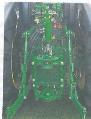
**Links:** Der neue 6R. | **Rechts:** Der Hydraulikblock wurde neu gestaltet: Die Anordnung der Anschlüsse ist vertikal und es gibt Druckentlastungshebel, die das Abkuppeln erleichtern. Die arretierbaren Unterlenker-Seitenstreben stammen neuerdings aus der John Deere-Eigenproduktion. | Fotos: Rueß
