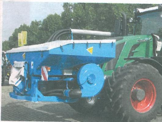
Mit einer Höhe von nur 1,12 m an der Stirnseite bietet der neue Fronttank sehr gute Sichtverhältnisse für den Fahrer. | Foto: Reichert
