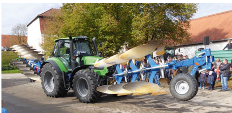
Der Pflug im Front- und Heckanbau soll für eine bessere Lastenverteilung sorgen.
