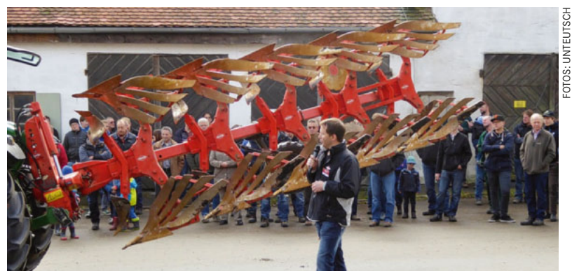
Der Volldrehpflug ist zwar schwer , aber er bringt mehr Leistung und das Pflügen geht insgesamt rationeller.
