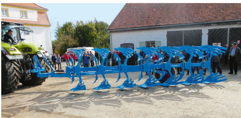
Mehr Flächenleistung beim Pflügen mit diesem Großpflug, aber dabei braucht man natürlich auch mehr Motorleistung.
