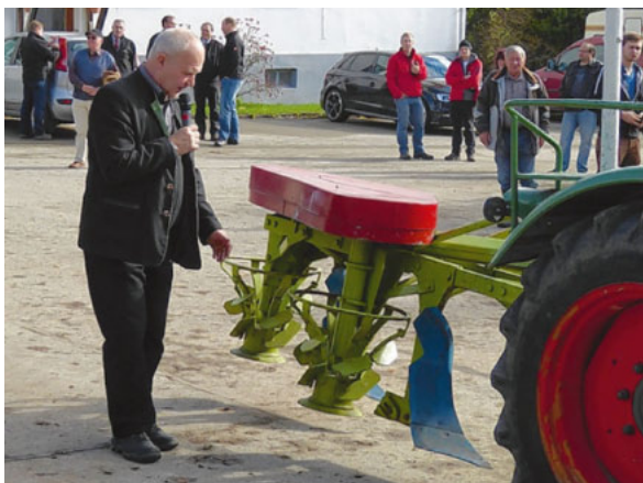
Der Fräspflug stellt eine Besonderheit dar. Neben der Pflugarbeit wurde der Boden auch gelockert.
