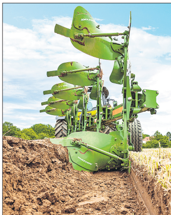
Die Grindel muss senkrecht ausgerichtet sein.
