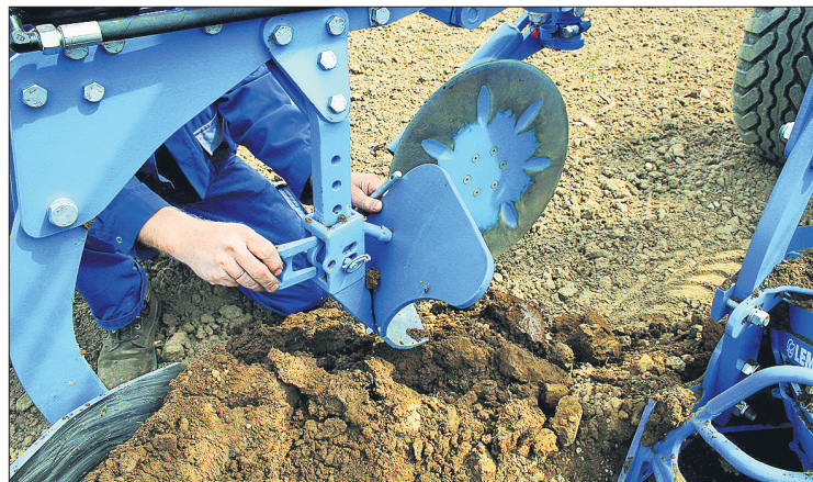
Vorschäler bzw. Düngereinleger und Scheibensech sind an die Arbeitstiefe anzupassen. FOTOS: WERKBILD
