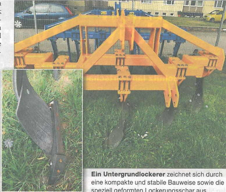
Ein Untergrundlockerer zeichnet sich durch eine kompakte und stabile Bauweise sowie die speziell geformten Lockerungsschar aus.
